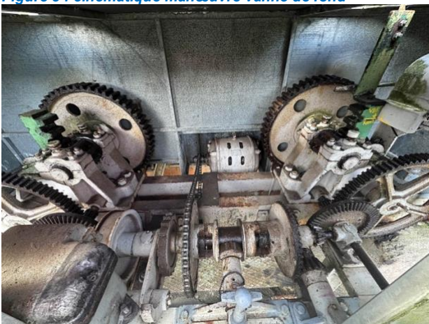
Figure 8 : cinématique manœuvre vanne de fond
