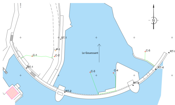
Figure 1-9 : Implantation sommaire des piézomètres (issue du DOE)
